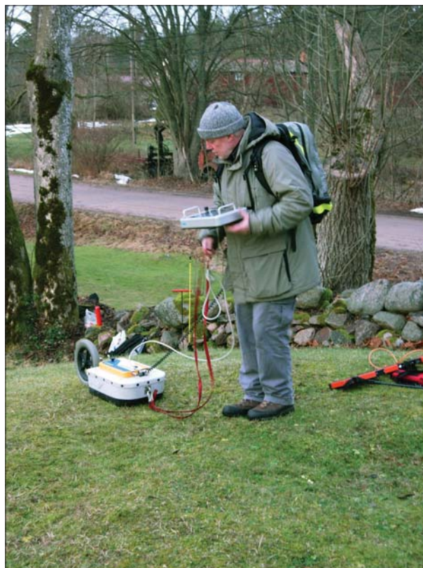
Figur 38. Markradarundersökning. Foto Marie Ohlsén, ÖLM.
